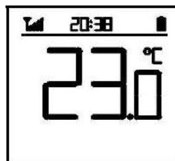
Figura 15. Unità termostato ambiente. Schermata operativa
